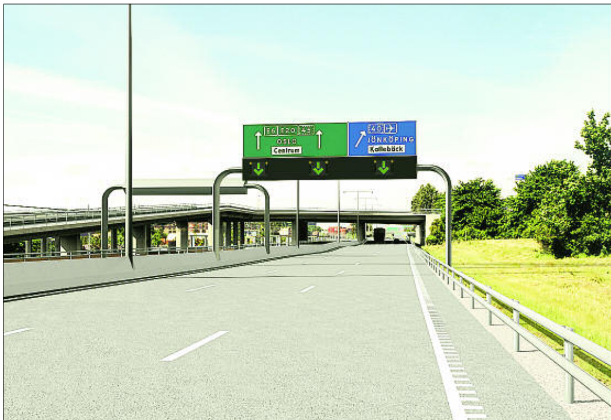
Premiär i Sverige. Bilden illustrerar hur portaler med dynamisk hastighetsstyrning kommer att se ut till sommaren på E 6 genom Mölndal. Bildanimering: Arcitec
