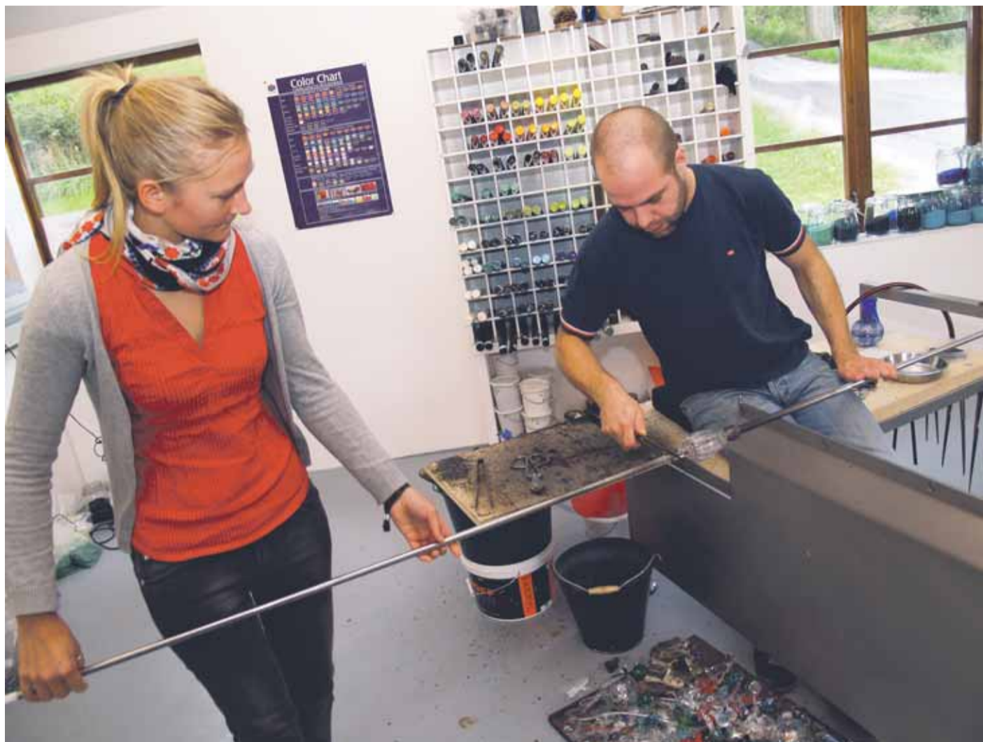
Råglaset blir som sirap när det värms upp till 1200 grader. Det gäller att arbeta snabbt två och två innan glaset kyls ner. Camilla och Frederik känner varandra väl och jobbar effektivt ihop.
